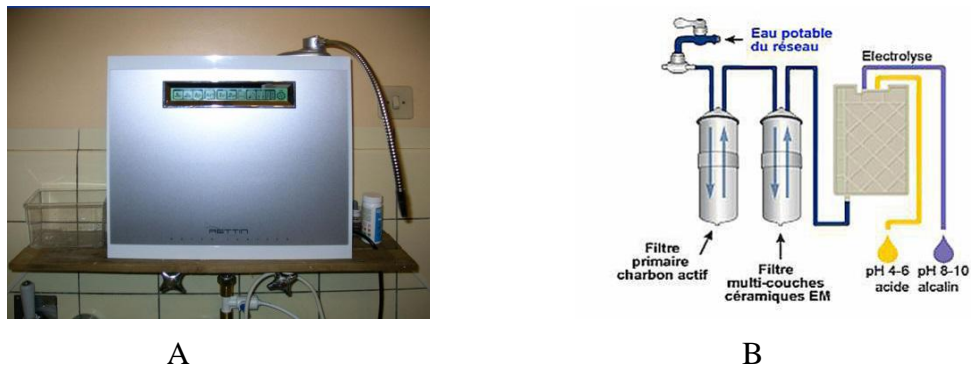
Figure 1 Appareil branché sur le réseau d'eau potable A Système de filtrage B
